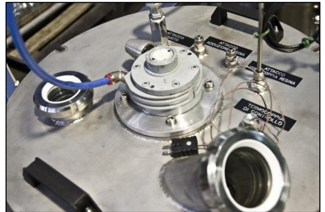
Figura 4- Dettaglio attacco utenze coperchio
